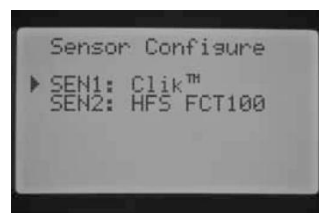
SEN 1 – метеодатчик SEN2 – датчик потока (HFS FCT100)
